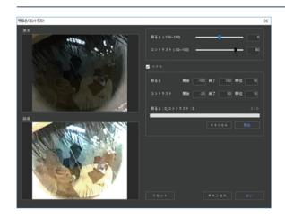
容疑者がスマートフォンで撮影していた写真の中に被害者の瞳に容疑者の影が 映りこんでいることがわかり、容疑を裏付ける決めての証拠とされた事件が ありました。AOSの画像解析フォレンジックの超解像度化の技術は、複数 フレームの画像ピクセル情報を計算し組み合わせることで、高解像度の画像に 変換し、瞳に映った人物像も浮き上がらせることが可能です。
